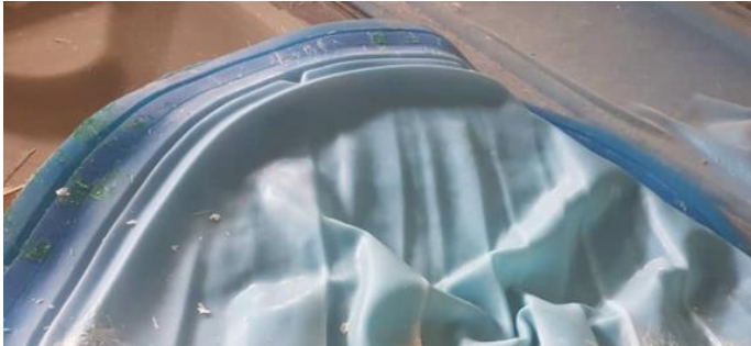
写真: Pipeco Sdn Bhd 社 (Klang, マレーシア) によって、ポリエステル樹脂製タンク・エンド・パネル成形に 1,200 回使用された後の、ACC シリコン社製バキューム膜の状態
